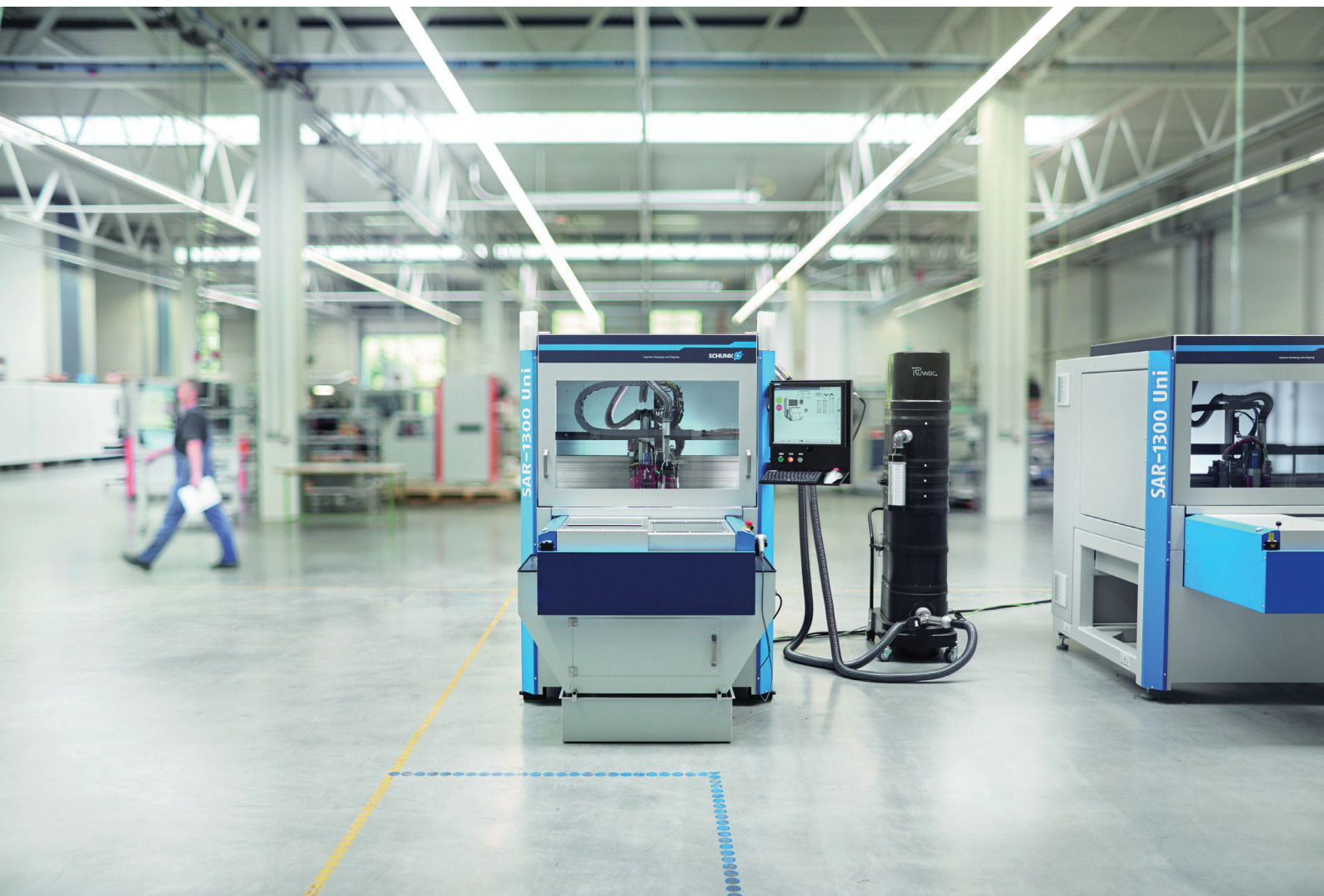
In der Nutzentrennmaschine für Leiterplatten von Schunk kommt der sicherheitszertifizierte Magnetsensor von Siko zum Einsatz. (Fotos: Siko)
